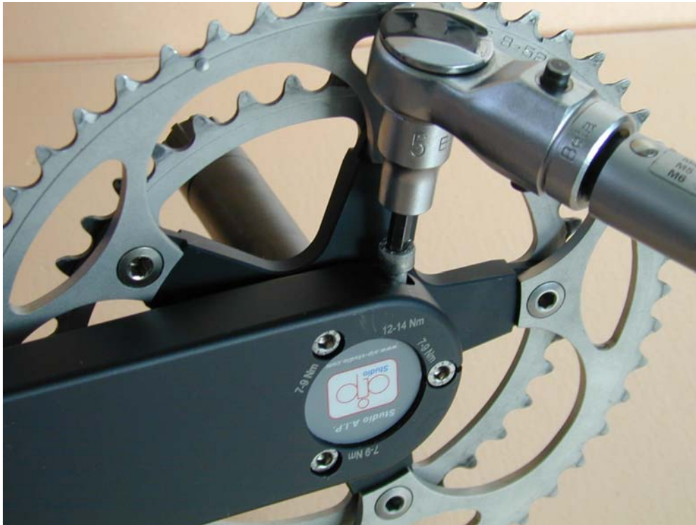
Figure 5 - Bloccaggio pedivella destra su perno centrale
