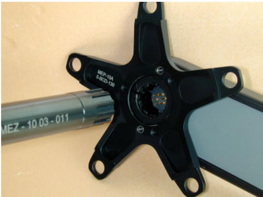
Figura 3 - Montaggio perno centrale su assieme pedivella
