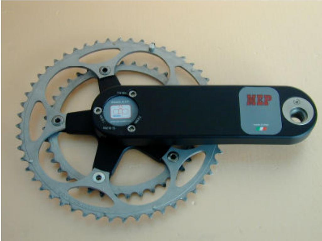
**Figura 4 - montaggio multiple/corone allo spider**
