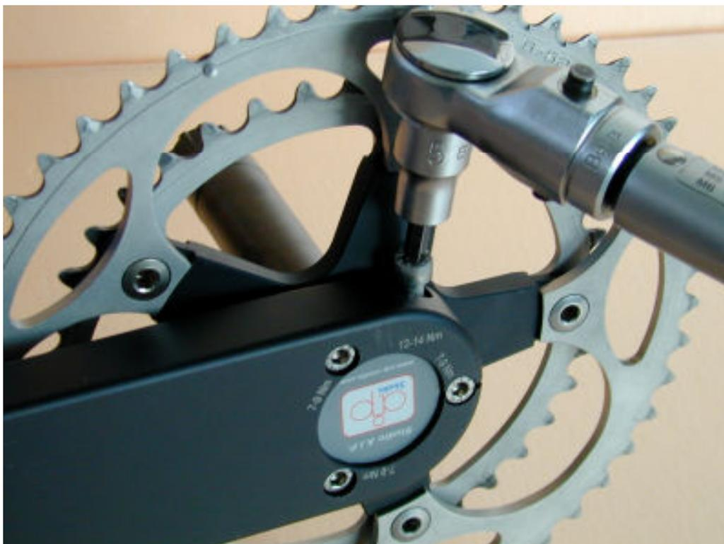
**Figura 5 - Bloccaggio pedivella destra su perno centrale**
