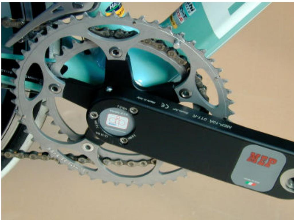
Figura 7 - Inserzione sistema MEP nel movimento centrale
